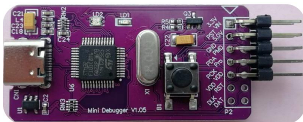
图 3-1 Mini Debugger 仿真器 + 转接板组装图
