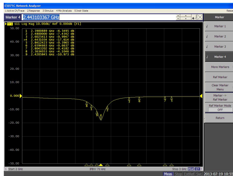
图 5 Nano Dongle 天线 S11
