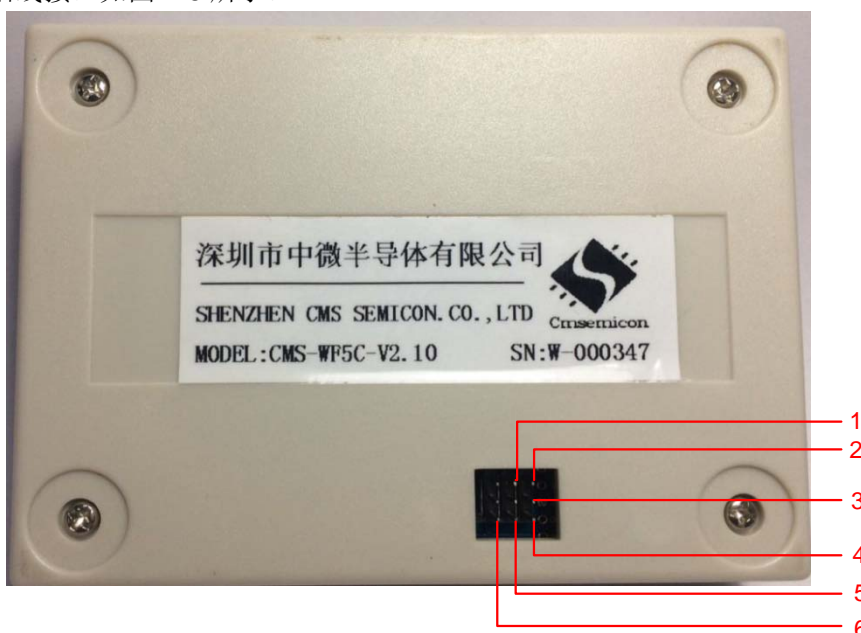
图 2-6: 烧写器与机台接口定义
